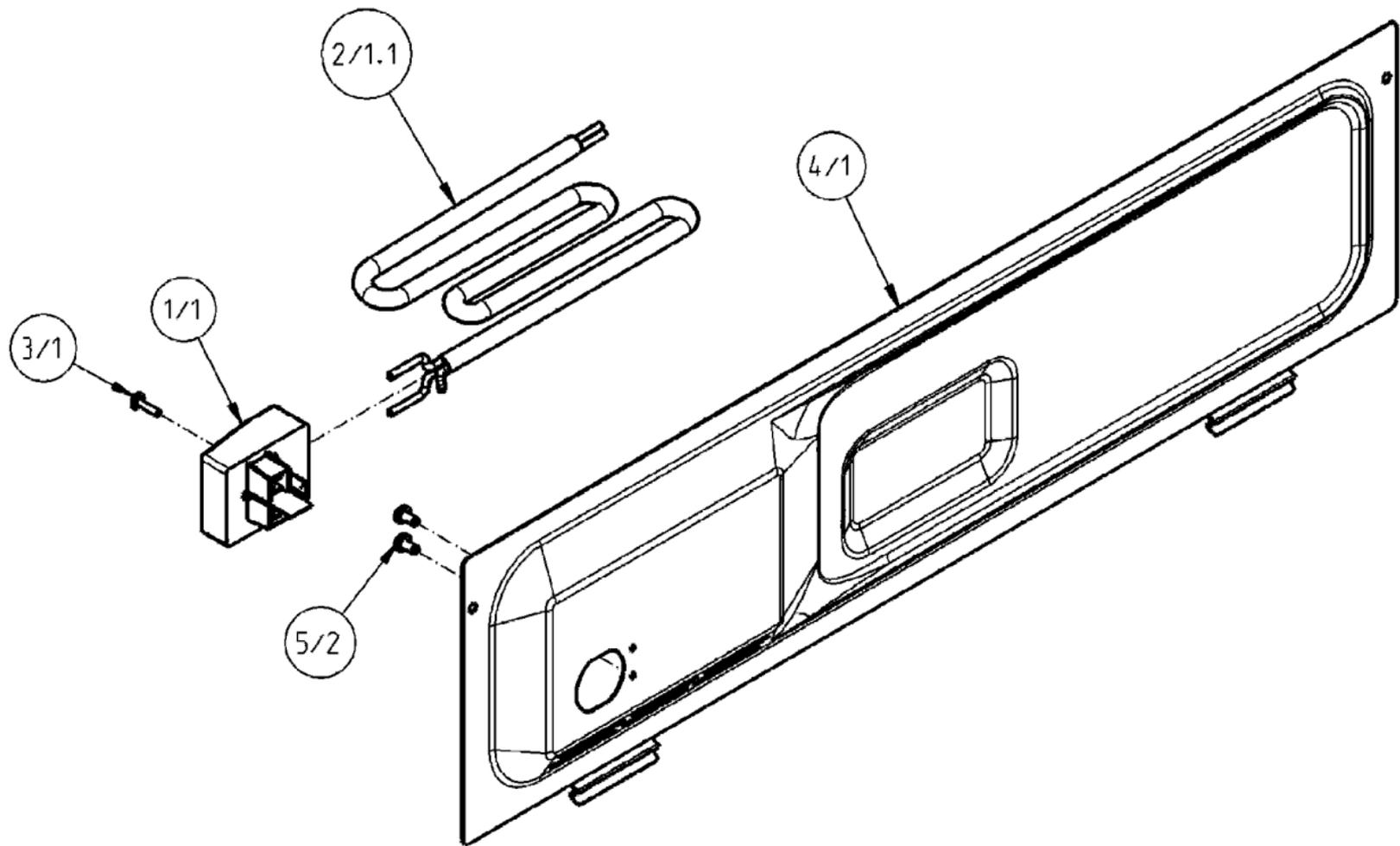
Sobre el labio de la chimenea se aplicará silicona con objeto de asegurar una unión estanca con la contrapuerta.
