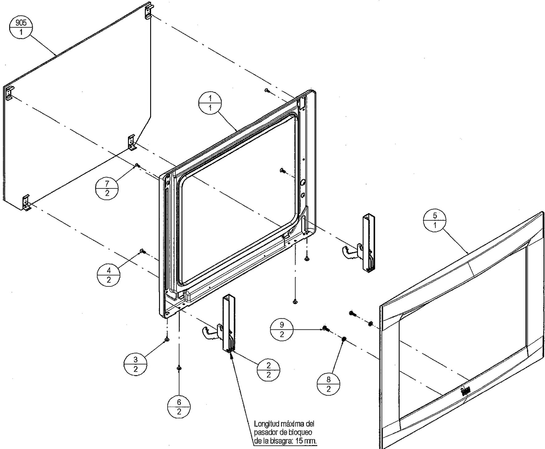
Longitud máxima del pasador de bloqueo de la bisagra: 15 mm.
