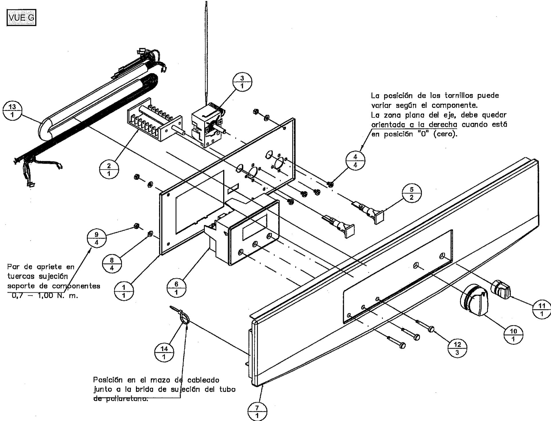
La posición de los tornillos puede variar según el componente.
