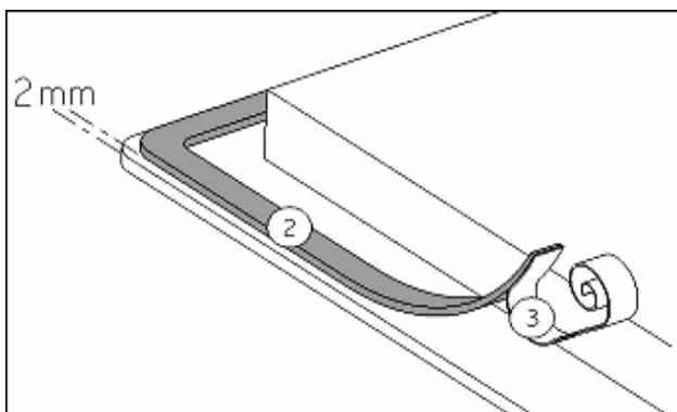
Die Dichtung (2) nach Abnehmen der Schutzfolie (3) mit 2 mm Abstand der Außer kannte des Glases aufkleben.
