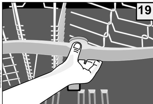
Pour démonter le bras d'irrotation supérieur: dévissez le support du bras dans le sens contraire des aiguilles d'une montre.
