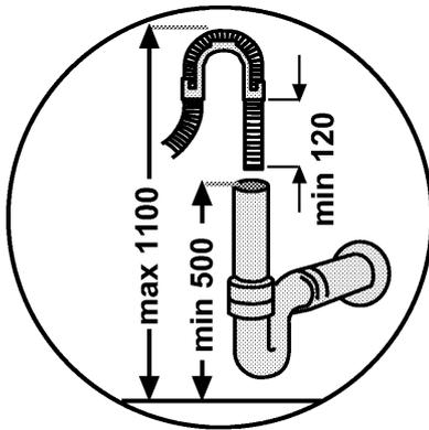
Si la longueur du tuyau n'est pas suffisante, faites appel à votre distributeur agréé pour avoir une rallonge fabriquée dans le même matériau que l'original. Souvenez-vous que la longueur du tuyau ne doit pas dépasser 4 mètres, même avec la rallonge. Si le tuyau de vidange a plus de 4 mètres de long, la vaisselle ne sera pas convenablement nettoyée.
