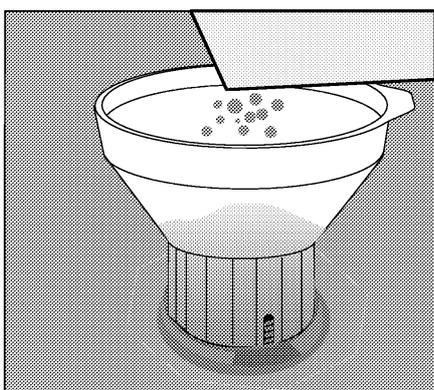
Pour adoucir l'eau dure, utilisez uniquement du sel en granules pour lave-vaisselle dans votre machine. N'utilisez jamais d'autres types de sel tels que du sel de table, du sel marin, du sel destiné à nourrir les animaux ou du sel culinaire. Ces types de sel ne se dissolvent pas facilement dans l'eau et risquent d'endommager votre appareil en le rendant irréparable.
