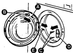
Ouvrir la porte. Dévisser la vis **A**, enlevez le doigt de l'interrupteur **B** et remettez la vis. Enlevez le vis **C** et la plaque de serrure **D**. Enlevez la vis de la couverture de la charnière **E**. Fermez la porte.
