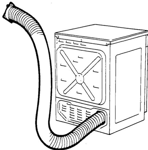
Le tuyau flexible peut être fixé à demeure sur un mur percé d'un trou permettant l'évacuation vers l'extérieur à travers le mur. Ne pas plier ou écraser le tuyau d'évacuation, cela provoquerait une mauvaise évacuation de l'air. Dans ce cas fixer sur la façade extérieure une grille de protection anti-oiseaux.
