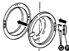
Retournez la porte et la monter sur le séchoir en position fermée. Serrez les vis **G** et monter la couverture de la charnière **F**. Ouvrez la porte.
