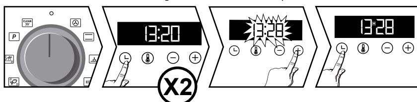
Appuyez sur la touche le symbole apparaît appuyez de nouveau sur . Ajustez le réglage de l'heure avec les touches + ou -. Validez avec la touche . L'enregistrement, de l'heure ajustée est automatique, au bout de quelques secondes.
