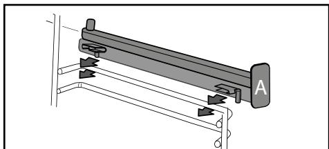
**NOTA :** la partie coulissante télescopique du rail doit se déplier vers l'avant du four, la butée **A** se trouve face à vous.
