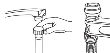
Relier le tuyau d'arrivée d'eau froide à un raccord fileté 20/27mm, en s'assurant qu'ils sont bien fixés entre eux. S'il s'agit de tuyaux neufs ou de tuyaux qui n'ont pas été utilisés depuis longtemps, laisser de l'eau couler dedans pour vérifier qu'elle en ressort bien claire et sans impureté. Si cette précaution n'est pas prise, le tuyau risquerait de s'obstruer, auquel cas le lave-vaisselle risquerait d'être endommagé.
