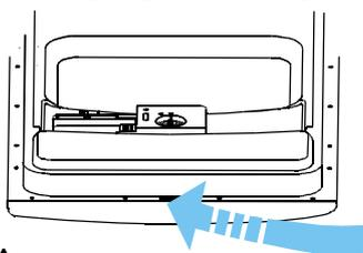
Pour nettoyer le bord autour de la porte, utilisez seulement un chiffon doux tiède et humide. Pour éviter que l'eau pénètre dans la fermeture de la porte et dans les composants électriques, n'utilisez pas de produit de nettoyage qu'on pulvérise, quel qu'il soit. N'utilisez pas non plus de produit de nettoyage abrasif ou un tampon à récurer sur les surfaces extérieures, car ils rayeront la finition. Certaines serviettes en papier peuvent aussi rayer ou laisser des marques sur la surface.
