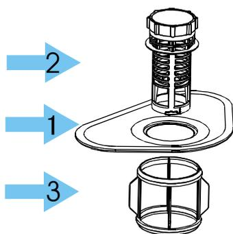
Le système de filtrage se constitue de filtre rugueux, d'un filtre plat (filtre principal) et de micro filtre (filtre fin).
