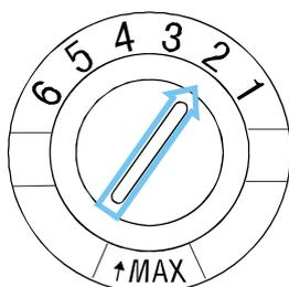
Une quantité mesurée de produit de rinçage est libérée pendant le rinçage final. Comme pour le détergent, la quantité de produit de rinçage nécessaire pour votre vaisselle dépend de la dureté de l'eau dans votre zone. Trop de produit de rinçage peut produire de la mousse et un voile ou des traînées sur la vaisselle. Si l'eau dans votre zone est très douce, vous pouvez vous passer de produit de rinçage. Vous pouvez aussi diluer le produit de rinçage avec une quantité équivalente d'eau.
