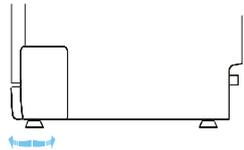
Une fois l'appareil dans son emplacement, réglez les pieds (en les vissant ou dévissant) pour ajuster leur hauteur jusqu'à ce que le lave-vaisselle soit à niveau. Dans tous les cas, l'appareil ne doit pas être incliné de plus de 2°.
