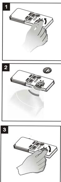
Pour ouvrir le distributeur, tournez le bouchon jusqu'à ce que la flèche soit en position ouvert, à gauche) et soulevez-le. Versez le produit de rinçage dans le distributeur, en faisant attention de ne pas faire déborder.
