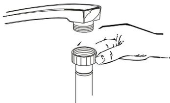
Connectez l'arrivée d'eau froide à un connecteur  $\frac{3}{4}$  et vérifiez la bonne connexion.
