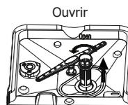
Pour nettoyer le filtre à déchets et le micro-filtre, utilisez une brosse de nettoyage. Puis, remontez les pièces du filtre comme indiqué dans la figure de gauche et réinsérez l'ensemble dans le lave-vaisselle dans son emplacement et en appuyant vers le bas.
