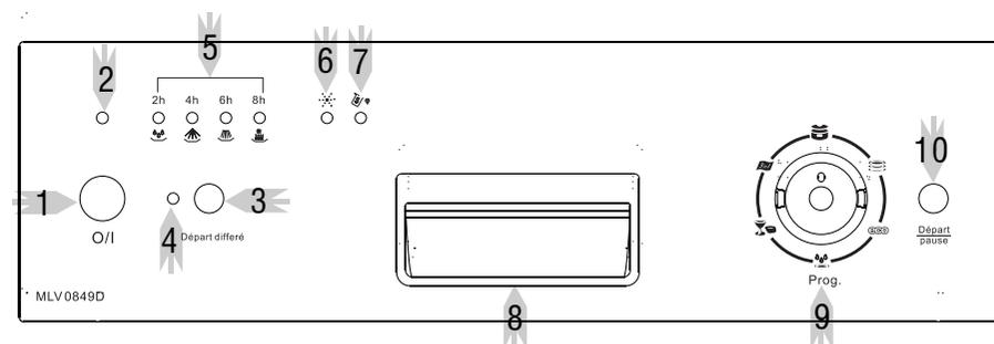
1. Bouton MARCHE/ARRET : pour activer/désactiver l'alimentation électrique. Veuillez noter que ce modèle possède une fonction 'mémoire' : si une coupure d'électricité se produit, la machine ne réinitialise pas le programme en cours. De ce fait, vous ne pouvez pas annuler un programme en éteignant l'appareil.
