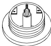
1. Dévissez le bouchon du réservoir de sel.
