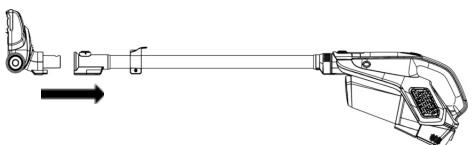
Introduzca el cepillo eléctrico para suelos duros en el tubo hasta que se enganche en la posición adecuada.
