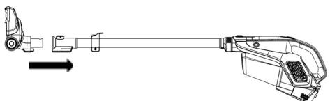
Insérez la brosse électrique pour sols durs sur le tube jusqu'à ce qu'elle s'enclenche dans la bonne position.
