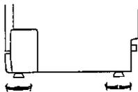
Une fois que vous avez mis le lave-vaisselle en place, la hauteur du lave-vaisselle peut être modifiée en vissant ou dévissant au niveau du pied. Dans tous les cas, l'appareil ne doit pas être incliné de plus de 2 degrés.
