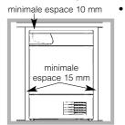
Si vous installez cet appareil sous un plan de travail, faites en sorte de laisser un espace de 10 mm entre le dessus de l'appareil et tout autre objet sur ou au-dessus de la machine, et un espace de 15 mm entre les côtés et les éléments
