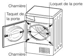
La porte de votre sèche-linge est réversible et les charnières peuvent être facilement changées de côté. Echangez diagonalement les supports de charnières et les vis d'obturation. Echangez le taquet de la porte et le loquet avec leur plaque d'obturation opposée (voir schéma ci-dessus).
