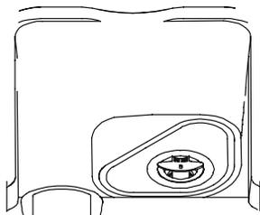
Pour de meilleures performances, le filtre doit être nettoyé régulièrement. Le filtre permet de retirer les résidus d'aliments de l'eau de lavage, permettant sa bonne circulation durant le cycle de lavage. Pour cette raison, il est fortement recommandé de retirer les résidus emprisonnés dans le filtre après chaque cycle de lavage. Pour cela, il suffit de rincer sous l'eau courante le filtre semi-circulaire et le bol.
