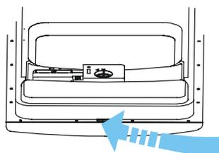
Pour nettoyer les côtés autour de la porte, n'utilisez qu'un chiffon humide et chaud. Pour éviter la pénétration de l'eau dans les loquets et les parties électriques de la porte, ne jamais utiliser un nettoyeur à spray.
