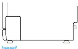
Après avoir positionné le lave-vaisselle, ajustez les pieds (vissez-les vers la droite ou la gauche) pour monter ou baisser l'appareil, ainsi que pour le mettre droit. Dans tous les cas, le lave-vaisselle ne peut être incliné de plus de 2°. Si l'appareil est un peu en hauteur, il fonctionnera mieux.
