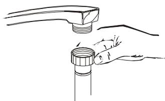
Connectez l'arrivée d'eau froide à un connecteur  $\frac{3}{4}$  et vérifiez la bonne connexion. Si les conduits d'eau sont neufs ou n'ont pas été utilisés depuis un certain temps, laissez couler l'eau pour vérifier que l'eau est claire et ne contient pas d'impureté. Si vous ne vérifiez pas, l'arrivée d'eau peut être bloquée et endommager l'appareil.
