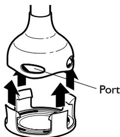
**REMARQUE :** veillez à ce que le protège-lame soit fixé avec les clips de montage positionnés entre les ports des embouts à lame.
