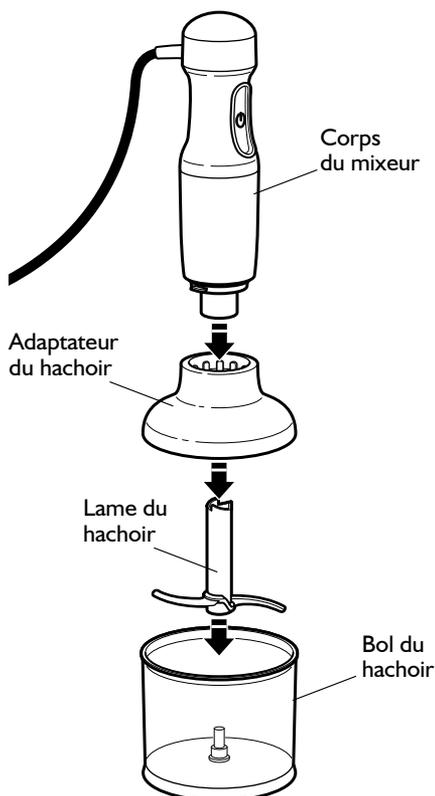
4. Placez le corps du mixeur sur l'adaptateur du hachoir, en les alignant bien pour les assembler.
