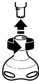
2. Insérez l'axe mélangeur dans le corps du mixeur et faites-le tourner jusqu'à ce qu'il s'enclenche.
