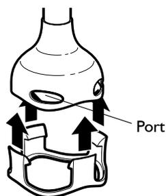
**REMARQUE :** veillez à ce que le protecteur antirayure soit fixé avec les clips de montage positionnés entre les ports des embouts à lame.
