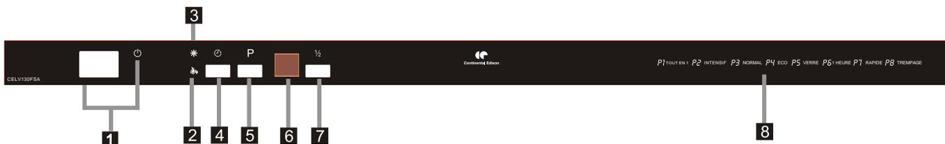
1. Touche ON/OFF : mise en marche ou arrêt de l'appareil.
