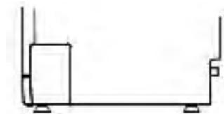
Une fois l'appareil en place, son horizontalité et sa hauteur peuvent être réglées en ajustant les pieds à vis. Dans tous les cas, l'appareil ne doit pas être incliné de plus de 2°.
