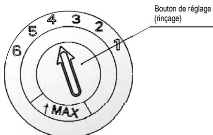
Le bouton de réglage du distributeur d'agent de rinçage est un sélecteur à 6 positions. Toujours démarrer sur la position "4". Si des traces apparaissent ou que le séchage est insuffisant, augmenter la quantité d'agent de rinçage en soulevant le capuchon du distributeur et en mettant le sélecteur sur "5". S'il reste encore des traces, régler sur le niveau encore supérieur jusqu'à obtenir un résultat parfait. Le réglage recommandé est de "4" (réglage usine).
