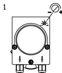
Zur Regelung die Einstellschraube wie in der Abbildung drehen. Die Einstellung sollte vom Fachpersonal des Reinigungsmittelieferanten vorgenommen werden.
