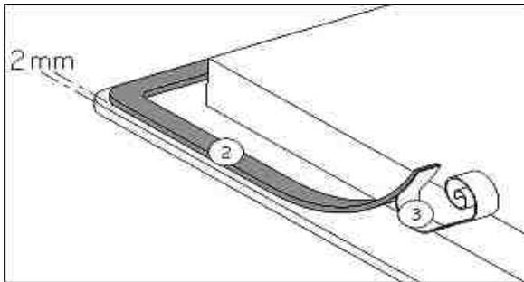
Die Dichtung (2) nach Abnehmen der Schutzfolie (3) mit 2 mm Abstand von der Außenkante des Glases aufkleben.
