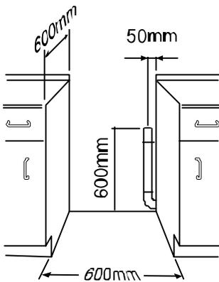
Cet appareil ne doit pas être encastré entre deux meubles ou deux autres appareils. L'arrière de l'appareil ne doit pas toucher le mur pour éviter un échauffement de celui-ci. Prévoir un espace libre d'au moins 600mm chaque côté.
