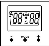
L'heure doit être réglée avant la première utilisation du four. Après le branchement électrique du four, le symbole (A) et trois "0" vont se mettre à clignoter sur l'écran. Appuyez simultanément sur les touches (+) et (-). Le symbole
