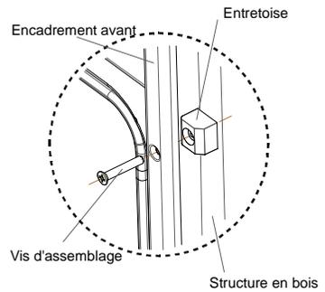
Insérez partiellement le four dans le meuble en le poussant. Ouvrez la porte du four, positionnez chaque vis d'assemblage en ayant pris soin de mettre les entretoises (bord arrondi vers l'avant) derrière l'encadrement et faites un tour de vis. Poussez complètement l'appareil vers le fond puis vissez sans trop forcer pour ne pas abîmer l'encadrement
