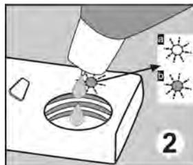
vérifier si vous devez ajouter ou non du produit de rinçage dans votre machine au moyen de l'indicateur de niveau de produit de rinçage situé sur le distributeur de détergent. Si l'indicateur est noir **b** le compartiment contient suffisamment de produit de rinçage, tandis que si l'indicateur est clair **a** vous devez ajouter du produit de rinçage.
