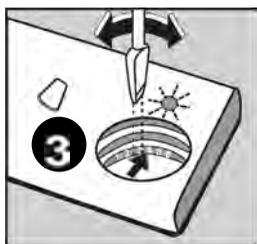
On peut régler le doseur de produit de rinçage de 1 à 6. Le doseur est réglé à la position 4 en usine.
