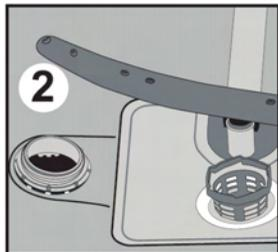
inférieur et retirez le couvercle du compartiment à sel en le tournant dans le sens contraire des aiguilles d'une montre. **1** **2** Versez le sel dans le compartiment au moyen de l'entonnoir (attention de ne pas mettre de sel à côté, sinon l'enlever aussitôt). **3** A la première utilisation, remplissez le compartiment avec 2 kg de sel et remplissez d'eau **4** à ras bord; revissez le couvercle. Remplissez le compartiment à sel (environ 1,5 kg) tous les 20 à 30 lavages.
