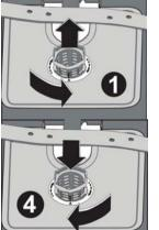
Tirez et retirez le filtre métal ou plastique. Séparez ensuite le filtre à déchets et le microfiltre. Rincez-le abondamment à l'eau courante. Réinstallez le filtre à déchets dans le microfiltre en faisant attention de bien faire correspondre les repères. Positionnez l'ensemble dans le filtre métal ou plastique et tournez-le dans le sens de la flèche (sens des aiguilles d'une montre); l'ensemble est verrouillé quand on peut voir la flèche sur le microfiltre.
