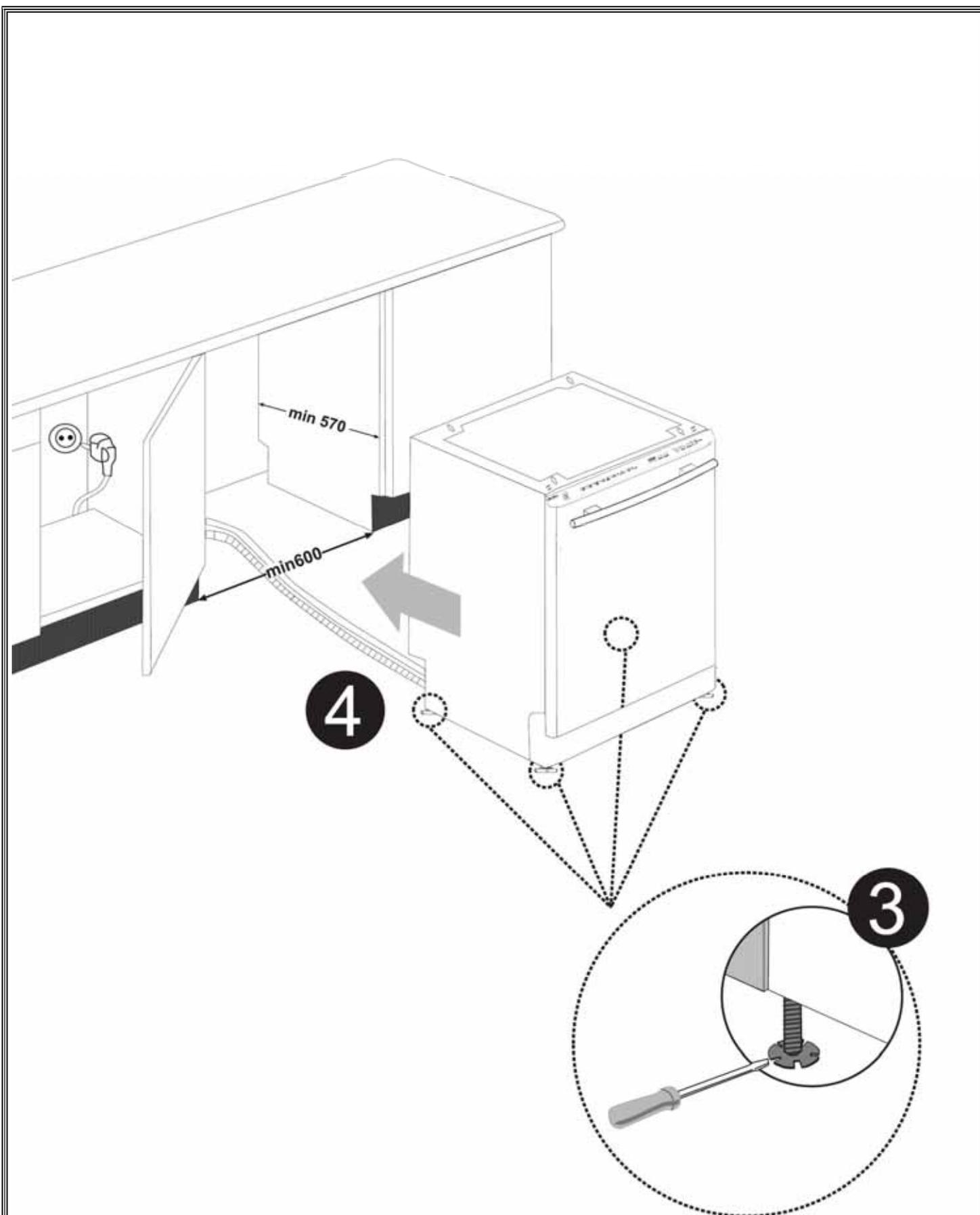
Réglez les pieds de la machine en fonction de la pente du sol et du niveau. shéma 3 Installez votre machine en la poussant sous le plan de travail en prenant soin de ne pas plier ou d'écraser les tuyaux. shéma 4
