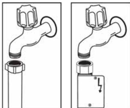
**NB :** Certains modèles utilisent un système Aquastop. Si votre machine est équipée de ce système, il y a du courant avec une tension dangereuse. Ne coupez jamais l'embout Aquastop et veillez à ce qu'il ne soit pas plié ou tordu.
