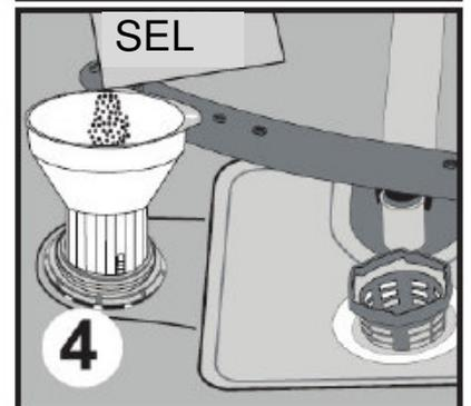
vaisselle (corrosion) en raison du débordement de sel dans l'appareil lors du remplissage du réservoir. Ainsi, le surplus de sel sera immédiatement enlevé au moment de l'opération de lavage.
