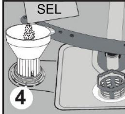
vide afin d'éviter d'endommager l'intérieur du lave vaisselle (corrosion) en raison du débordement de sel dans l'appareil lors du remplissage du réservoir. Ainsi, le surplus de sel sera immédiatement enlevé au moment de l'opération de lavage.
