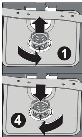
Pour extraire et nettoyer le groupe filtrant, tournez-le dans le sens inverse des aiguille d'une montre et retirez-le en le soulevant. **1**
