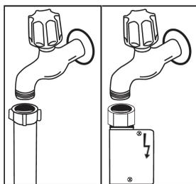
**NB :** Certains modèles utilisent un système Aquastop. Si votre machine est équipée de ce système, il y a du courant avec une tension dangereuse. Ne coupez pas l'embout Aquastop et veillez à ce qu'il ne soit pas plié ou tordu.
