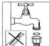
**NB** : Certains modèles utilisent un système Aquastop. Si votre machine est équipée de ce système, il y a du courant avec une tension dangereuse. Ne coupez jamais l'embout Aquastop et veillez à ce qu'il ne soit pas plié ou tordu.
