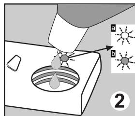
Revissez le couvercle de manière à ce que les picots correspondent. Vous pouvez vérifier si vous devez ajouter ou non du produit de rinçage dans votre machine au moyen de l'indicateur de niveau de produit de rinçage situé sur le distributeur de détergent. Si l'indicateur est noir **b** le compartiment contient suffisamment de produit de rinçage, tandis que si l'indicateur est clair **a** vous devez ajouter du produit de rinçage.
