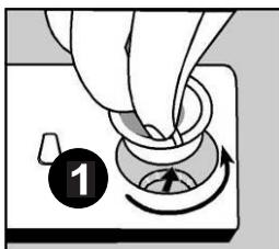
Pour verser le produit de rinçage, dévissez le bouchon du compartiment. **1** Remplissez le compartiment jusqu'à ce que l'indicateur de niveau de produit de rinçage noircisse **2b**.
