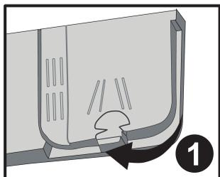
Pousser le loquet 1 pour ouvrir le compartiment à détergent comme indiqué sur l'illustration. On peut mesurer la bonne quantité de détergent au moyen des lignes inscrites dans le bac à détergent. Le bac à détergent peut contenir jusqu'à 40 cm<sup>3</sup> de détergent. Ouvrir l'emballage de détergent pour lave-vaisselle et verser dans le grand compartiment
