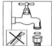
NB : Certains modèles utilisent un système Aquastop. Si votre machine est équipée de ce système, il y a du courant avec une tension dangereuse. Ne coupez jamais l'embout Aquastop et veillez à ce qu'il ne soit pas plié ou tordu.
