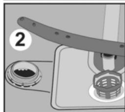
tournant dans le sens contraire des aiguilles d'une montre ❶ ❷. Versez le sel dans le compartiment au moyen de l'entonnoir (attention de ne pas mettre de sel à côté, sinon l'enlever aussitôt) ❸. A la première utilisation, remplissez le compartiment avec 2 kg de sel et remplissez d'eau ❹ à ras bord ; revissez le couvercle. Remplissez le compartiment à sel (environ 1,5 kg) tous les 20 à 30 lavages.
