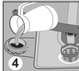
Ne mettez pas de sel de table dans votre machine, ce qui pourrait altérer le fonctionnement de l'adoucisseur avec le temps. Quand vous mettez votre lave-vaisselle en route, le compartiment à sel se remplit d'eau. Par conséquent, versez le sel régénérant avant de démarrer la machine.
