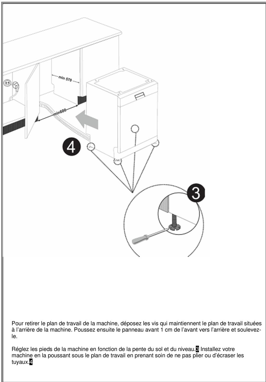
Pour retirer le plan de travail de la machine, déposez les vis qui maintiennent le plan de travail situées à l'arrière de la machine. Poussez ensuite le panneau avant 1 cm de l'avant vers l'arrière et soulevez-le.
