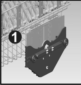
Le mécanisme de réglage de la hauteur du panier supérieur de votre machine a été conçu pour vous donner la possibilité d'ajuster la hauteur de ce panier supérieur vers le haut ou vers le bas, sans l'enlever de la machine lorsqu'il est plein. Et créer ainsi des espaces plus grands ou plus petits entre les paniers supérieur et inférieur. Le panier de votre machine a été réglé à la position supérieure en réglage d'usine.
