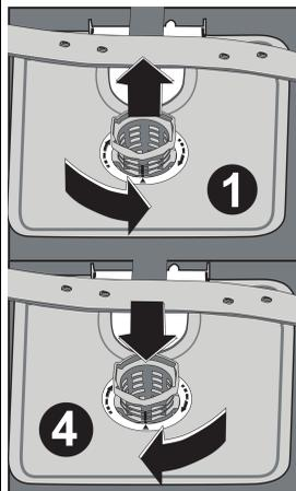
Pour extraire et nettoyer le groupe filtrant, tournez-le dans le sens des aiguilles d'une montre et retirez-le en le soulevant. **1**
