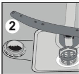
l'adoucisseur, enlevez d'abord le panier inférieur, puis dévissez le bouchon en le tournant dans le sens inverse des aiguilles d'une montre. 1 et 2
