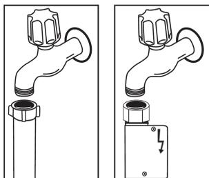
**NB :** Certains modèles utilisent un système Aquastop. Si votre machine est équipée de ce système, il y a du courant avec une tension dangereuse. Ne coupez jamais l'embout Aquastop et veillez à ce qu'il ne soit pas plié ou tordu.
