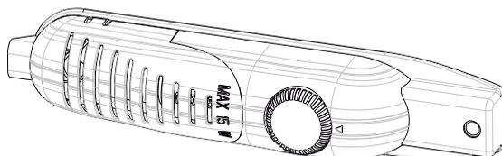
Le thermostat régule automatiquement la température interne des compartiments réfrigérateur et congélateur. En tournant le bouton de la position 1 à la position 5, vous pouvez obtenir des températures de plus en plus froides. La position «•» indique que le thermostat est arrêté et que le refroidissement n'est pas activé.
