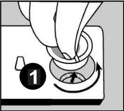
Remplissez le compartiment jusqu'à ce que l'indicateur de niveau de produit de rinçage noircisse 2b. Revissez le bouchon de manière à ce que les
