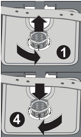
Pour extraire et nettoyer le groupe filtrant, tournez-le dans le sens inverse des aiguilles d'une montre et retirez-le en le soulevant. **1**
