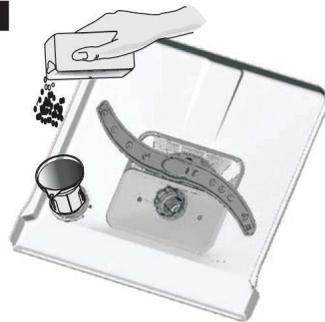
**Versez uniquement le sel avant de démarrer un programme complet de lavage.** Cela évitera que des grains de sel ou de l'eau salée ne restent dans le fond de l'appareil durant une longue période, ce qui pourrait causer de la corrosion.
