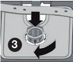
3. Remplacez les filtres dans leur logement en veillant à ce qu'ils soient verrouillés : la flèche sur le microfiltre doit être visible.
