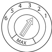
Ajustez la quantité de liquide de rinçage en fonction de la dureté de l'eau. Effectuez un premier cycle de lavage avec le distributeur en position 3 (réglage par défaut). Vous adapterez ensuite le dosage correct pour votre habitation : sélectionnez un réglage plus élevé si des taches d'eau se forme sur votre vaisselle après le lavage, ou un réglage plus faible s'il reste des tache bleues lorsque vous essuyez la vaisselle à la main.
