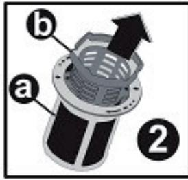
1. Tournez le filtre à déchets dans le sens inverse des aiguilles d'une montre pour le déboîter, soulevez les filtres et retirez-les.
