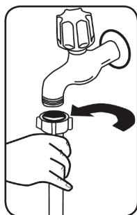
d'eau neuf ou longtemps inutilisé à votre lave-vaisselle, faites couler de l'eau dans celui-ci pendant un moment. Raccordez manuellement le tuyau d'arrivée d'eau directement au robinet d'arrivée. La pression au robinet doit être au minimum de 0,03 MPa et au maximum de 1 MPa. Si la pression d'eau est supérieure à 1 MPa, installez un dispositif réducteur de pression entre le robinet et le tuyau.
