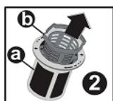
Rincez-le abondamment à l'eau courante. Réinstallez le filtre à déchets dans le microfiltre en veillant à bien faire correspondre les repères. Positionnez l'ensemble dans le filtre en métal ou plastique et tournez-le dans le sens de la flèche (sens des aiguilles d'une montre) ; l'ensemble est verrouillé lorsque la flèche sur le microfiltre est visible. ④
