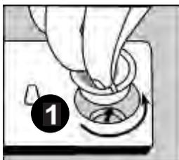
Pour verser le produit de rinçage, dévissez le bouchon du compartiment. **1** Remplissez le compartiment jusqu'à ce que
