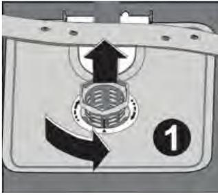
Pour extraire et nettoyer le groupe filtrant, tournez-le dans le sens inverse des aiguilles d'une montre et retirez-le en le soulevant ❶.
