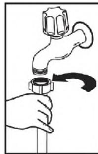
N'utilisez jamais le tuyau d'arrivée d'eau de votre ancien appareil. Utilisez le tuyau neuf fourni avec cet appareil.
