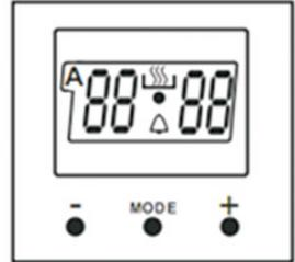
1- Appuyez sur les touches + et - simultanément. Vous pouvez avoir à répéter cette opération 2 ou 3 fois jusqu'à ce qu'un symbole et un point clignotant au centre de l'écran apparaissent, indiquant que la minuterie se trouve en "mode réglage".
