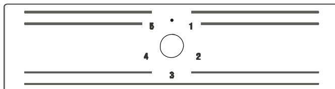
Le thermostat du congélateur régule automatiquement la température interne des compartiments. Pour obtenir des températures plus basses, tourner le bouton de la position « 1 » à la position « 5 ».
