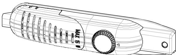
El termostato regula automáticamente la temperatura interna del compartimento frigorífico y del compartimento congelador. Para obtener temperaturas más frías deberemos girar el mando del termostato desde la posición 1 a la posición 5.
