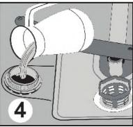
vaisselle (corrosion) en raison du débordement de sel dans l'appareil lors du remplissage du réservoir. Ainsi, le surplus de sel sera immédiatement enlevé au moment de l'opération de lavage.
