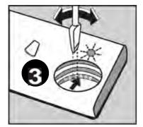
vérifier si vous devez ajouter ou non du produit de rinçage dans votre machine au moyen de l'indicateur de niveau de produit de rinçage situé sur le distributeur de détergent. Si l'indicateur est noir le compartiment contient suffisamment de produit de rinçage, tandis que si l'indicateur est clair vous devez ajouter du produit de rinçage.
