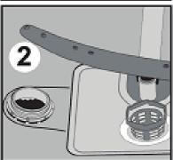
l'adoucisseur, enlevez d'abord le panier inférieur, puis dévissez le bouchon en le tournant dans le sens inverse des aiguilles d'une montre. I et 2
