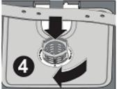
Tirez et retirez le filtre métal ou plastique. Séparez ensuite le filtre à déchets et le microfiltre. Rincez-le abondamment à l'eau courante. Réinstallez le filtre à déchet dans le microfiltre en faisant attention de bien faire correspondre les repères. Fixez le microfiltre sous le filtre métal ou plastique et tournez-le dans le sens de la flèche; l'ensemble est verrouillé quand on peut voir la flèche sur le microfiltre.
