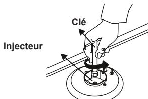
flamme afin de vérifier si elle est stable. La position de la vis de réglage du ralenti doit être desserrée pour la conversion du gaz au gaz naturel. Pour la conversion du gaz naturel au gaz, la vis de réglage du ralenti doit être resserrée. Vérifier que l'appareil est débranché de l'alimentation électrique et que l'alimentation du gaz est ouverte.
