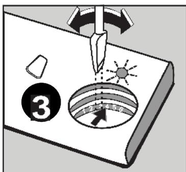
On peut régler le doseur de produit de rinçage de 1 à 6. Le doseur est réglé à la position 3 en usine.
