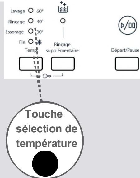
**REMARQUE:** Lorsque vous sélectionnez le programme à 90 ° valeur de la température maximale du programme sélectionné n'est pas affiché sur le panneau d'affichage. Lorsque la valeur de la température est abaissée à 60 °, 40 °, 30 °, (lavage à froid) les niveaux de température de réglage de température en appuyant sur, diminution de la valeur de température est affichée sur le panneau d'affichage.
