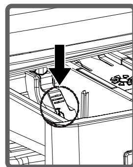
Nettoyez-le à grande d'eau et à l'aide d'une brosse à dents usagée. Enlevez le siphon de l'assouplissant et nettoyez soigneusement les résidus d'assouplissant. Nettoyez et remettez le siphon en place et vérifiez qu'il est bien en place
