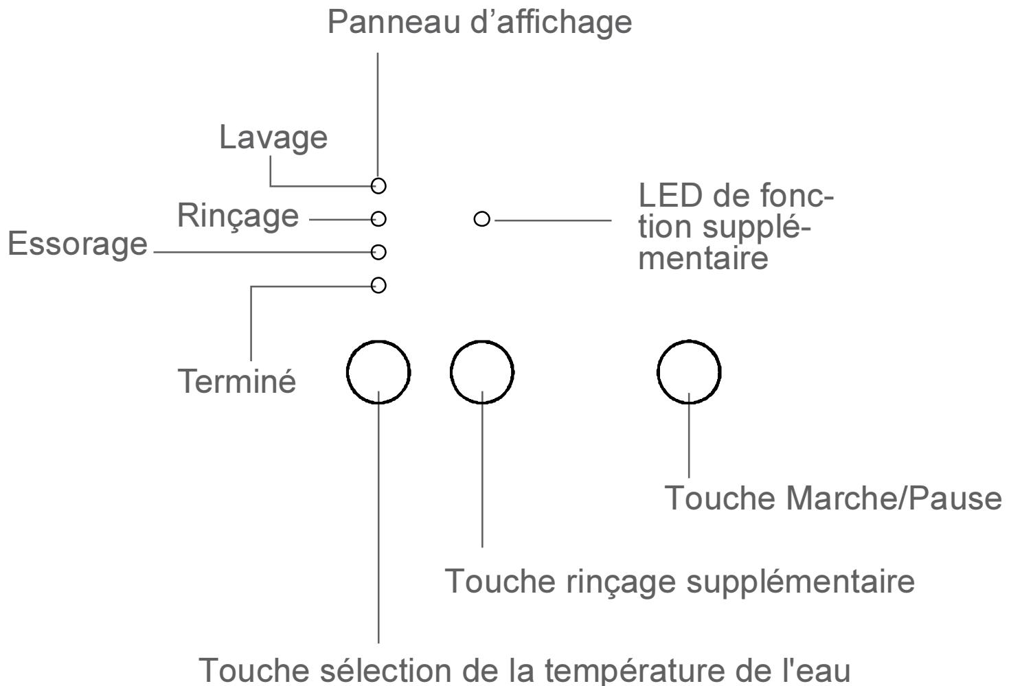
À partir des LED de fonction de votre machine, la température de l'eau de lavage de votre machine, les fonctions auxiliaires que vous avez sélectionnées et le stade du programme que vous exécutez sur votre machine. (▷ prélavage / état de lavage, ⚡ étape de rinçage, Ⓜ étape d'essorage).
