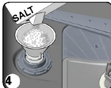
Si votre lave vaisselle est équipé d'un indicateur du niveau de sel, vous pouvez vérifier si la quantité de sel est suffisante pour le bon fonctionnement de votre appareil. Vérifier l'indicateur transparent du couvercle du bac de sel. S'il est vert, le niveau de sel est suffisant. S'il est transparent, vous devez ajouter du sel.
