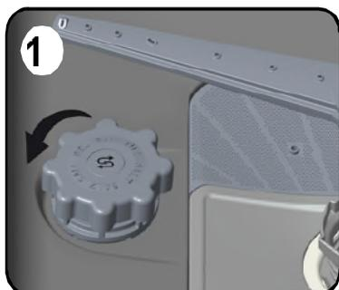
l'adoucisseur, enlevez d'abord le panier inférieur, puis dévissez le bouchon en le tournant dans le sens inverse des aiguilles d'une montre. **1** et **2**
