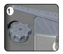
l'adoucisseur, enlevez d'abord le panier inférieur, puis dévissez le bouchon en le tournant dans le sens inverse des aiguilles d'une montre. I et 2
