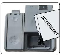
jusqu'à 40 cm<sup>3</sup> de détergent. Ouvrir l'emballage de détergent pour lave-vaisselle et verser dans le grand compartiment prélavage 25 cm<sup>3</sup> de détergent.
