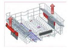
Le mécanisme de réglage de la hauteur du panier supérieur de votre machine a été conçu pour vous donner la possibilité d'abaisser ou de réhausser le panier supérieur sans devoir le retirer lorsqu'il est plein. Cela permet de créer des espaces de rangement plus hauts ou plus bas entre les paniers supérieur et inférieur. Le panier supérieur est réglé en position supérieure en réglage d'usine.
