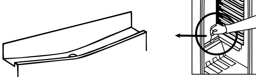
est recueillie dans le bac d'évaporation et s'évapore automatiquement. Le plateau d'évaporation et l'orifice d'évacuation de l'eau de dégivrage doivent être nettoyés régulièrement avec la tige de nettoyage du conduit de dégivrage pour éviter que l'eau ne s'accumule dans le bas du réfrigérateur.
