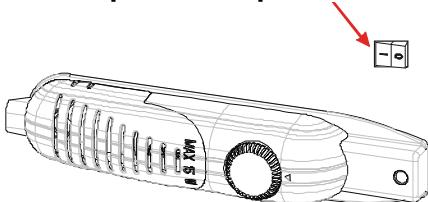
Afin d'assurer un fonctionnement approprié dans une température ambiante inférieure à 20°C, appuyez sur le bouton qui se trouve tout près du thermostat. Appuyez à nouveau sur le bouton pour le mettre hors tension lorsque la température est élevée (au-dessus de 20°C).
