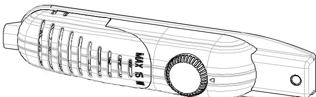
La température intérieure du congélateur et du réfrigérateur est réglée automatiquement par le thermostat. Afin d'obtenir des températures plus basses, tourner le bouton à partir de la position 1 vers la position 5.
