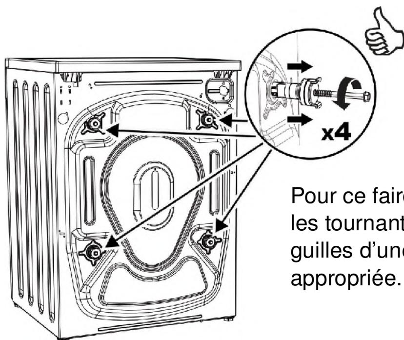
Pour ce faire, dévissez ces vis en les tournant dans le sens des aiguilles d'une montre avec une clé appropriée.
