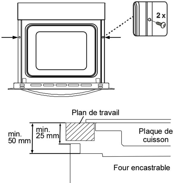
Ouvrez la porte du four et fixez 2 vis dans les orifices situés sur le cadre du four. Ouvrez la porte du four et fixez 2 vis dans les orifices situés sur le cadre du four. Lorsque le cadre du four touche la partie en bois, serrez les vis.
